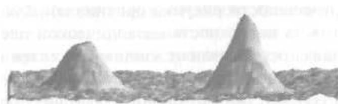
Рис. 13.3. Оксидные островки, сформированные зондовым окислением кремния в режиме постоянной (слева) и переменной (справа) полярности импульсов тока.
