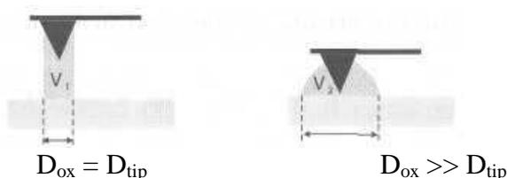
Рис. 12.2. Схематическое изображение иглы зонда относительно поверхности
